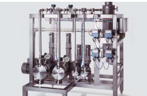
Präzise bei hohem Druck: LEWA Dosierpumpen und -anlagen in der Chromatografie
