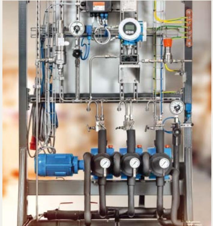
Zur Gewährleistung einer konstanten Qualität des Endproduktes im Extrusionsprozess ist die Treibmitteldosierung von großer Bedeutung. Die LEWA Testanlage wurde für alle bekannten Treibmittel konzipiert, inkl. einer Kühleinrichtung für CO<sub>2</sub> und einer explosionsgeschützten Ausführung für brennbare Treibmittel.
